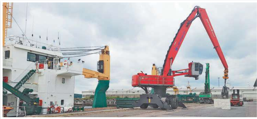
Der Hafenmobilkran vom Typ Mantsinen 90 entlädt ein Frachtschiff, das Zellstoff an Bord hat.
