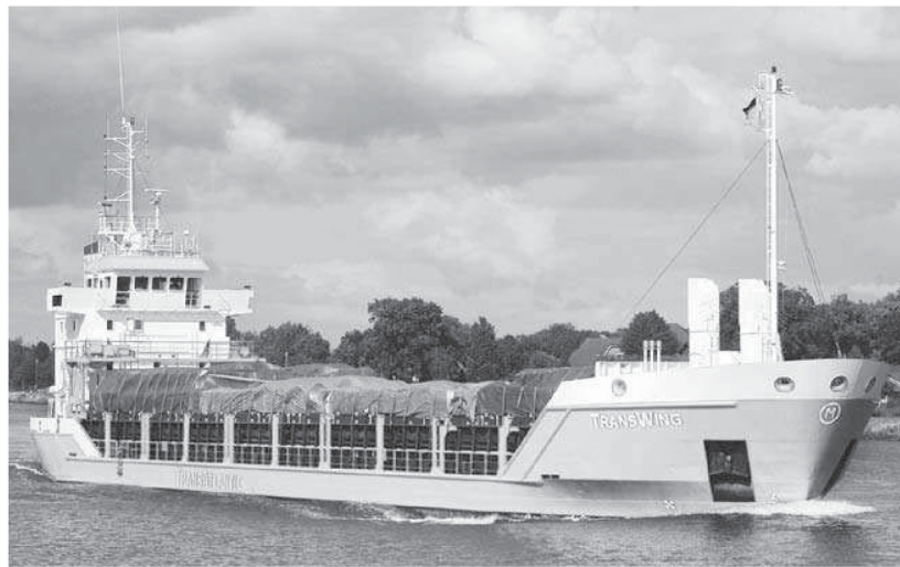
Der 90 Meter lange 4100-Tonnen-Bulker „Transwing“ entstand 1999 in Harlingen
